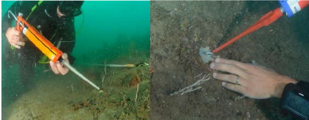
Figure 7: Mise en place d'un repère dans la roche.
